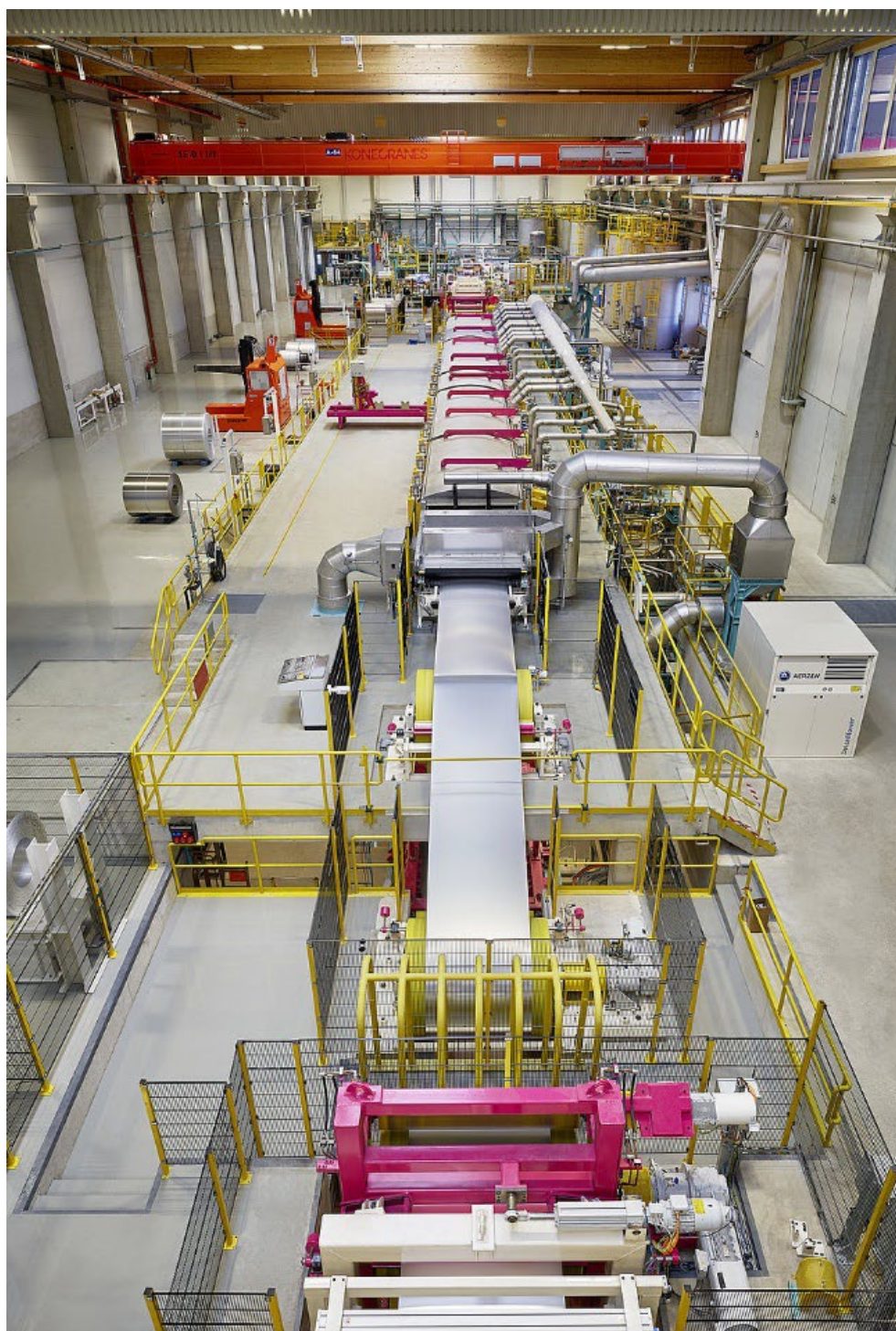
Die neue ANDRITZ-Oberflächenbehandlungsline für Aluminiumbänder bei AMAG wird mit grüner Energie beheizt und verfügt über fortschrittliche Digitalisierung für hohe Qualität und Produktivität. (©AMAG)
